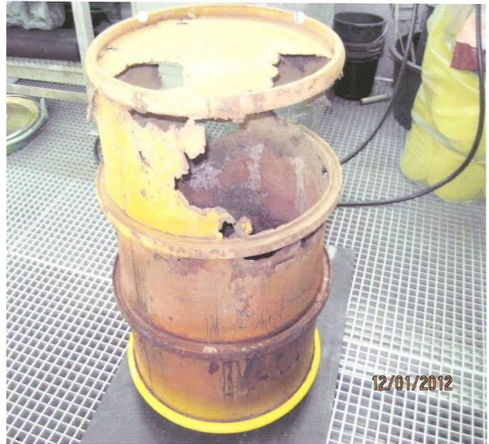
Rostfass Kaverne Brunsbüttel
